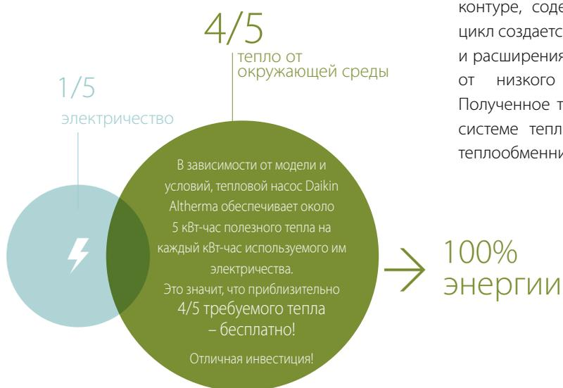
Тепловой насос «воздух-вода» Daikin Altherma использует экологически устойчивый источник энергии, извлекая тепло из наружного воздуха. В замкнутом контуре, содержащем хладагент, термодинамический цикл создается за счет испарения, конденсации, сжатия и расширения. Таким образом, тепло «перекачивается» от низкого уровня температуры к высокому. Полученное тепло доставляется в дом к центральной системе теплоснабжения здания потребителя через теплообменник.
