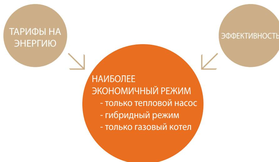
В зависимости от температуры наружного воздуха, цены на энергоносители и внутренней тепловой нагрузки гибридный тепловой насос Daikin Altherma всегда выбирает наиболее экономичный режим работы: работу теплового насоса, газового бойлера, по отдельности или одновременно.
