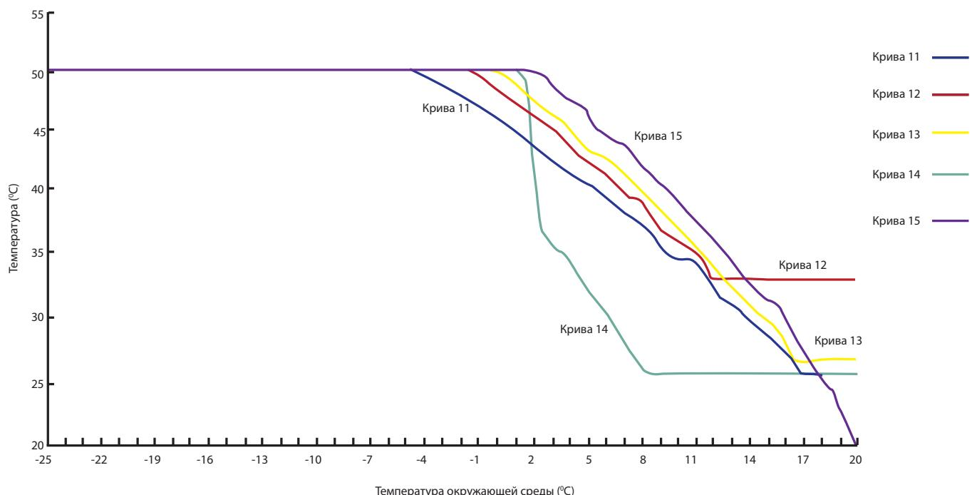
Параметр 5 используется для настройки пересмотренного значения температуры кривой отопления, чтобы отрегулировать заданную температуру для кривой отопления.
