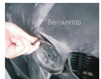
С. Отвинтите шурупы двигателя (рис. 5)
