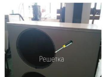
В. Гаечным ключом отвинтите шурупы и выньте вентилятор (рис. 3, 4)
