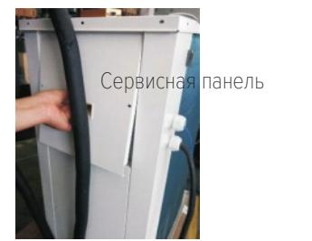
Д. Снимите сервисную панель (рис. 6)
