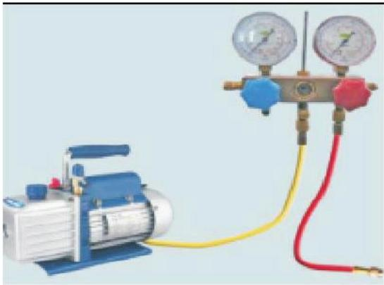
3. Подготовьте вакуумный насос и манометр.
